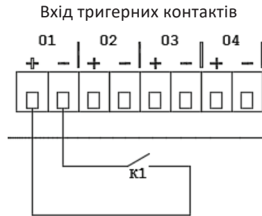
Мал. 3.4. Схема підключення зовнішніх сигналів управління до УКІМО без контролю цілісності
