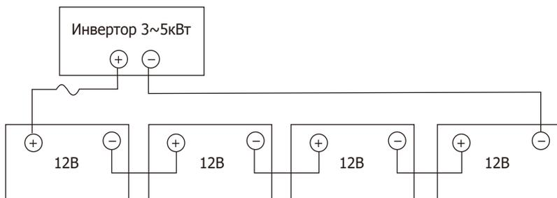
3. Вставьте обжатый кабель в клеммы подключения АКБ на инверторе и убедитесь что момент затяжки болта соответствует 2-3 Н\*м. Убедитесь в соответствии полярности АКБ полярности инвертора и проверьте надежность электрического соединения.
