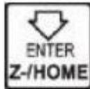
**А:** В режиме «НОМЕ» нажмите для запуска функции поиска нуля машины по всем осям. Порядок поиска нуля следующий: Z/X/Y/A. При отсутствии оси А порядок следующий Z/X/Y.
