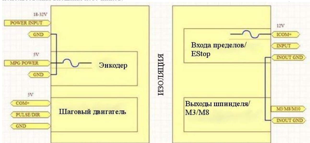
Рисунок 2-1. Подключение источников питания
