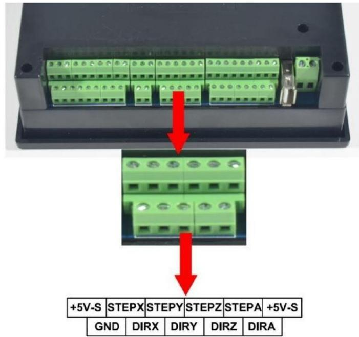
Рисунок 2-7. Интерфейс подключения двигателей
