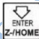
запустится режим поиска нуля станка по всем осям. Принцип действия такой же, как и при поиске нуля по отдельной оси: после нахождения нуля по одной оси система автоматически переходит к поиску по другой оси. Порядок поиска по осям следующий: X, Y, Z, A. Окончание поиска показано на рисунке 3-61.
