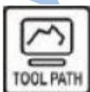
для переключения к отображению координат либо управляющей траектории, как показано на рисунке 3-13. На рисунках 3-14 и 3-15 показана управляющая траектория. В этом режиме на экране будет отображаться управляющая траектория и после завершения выполнения программы (см. рисунок 3-16).
