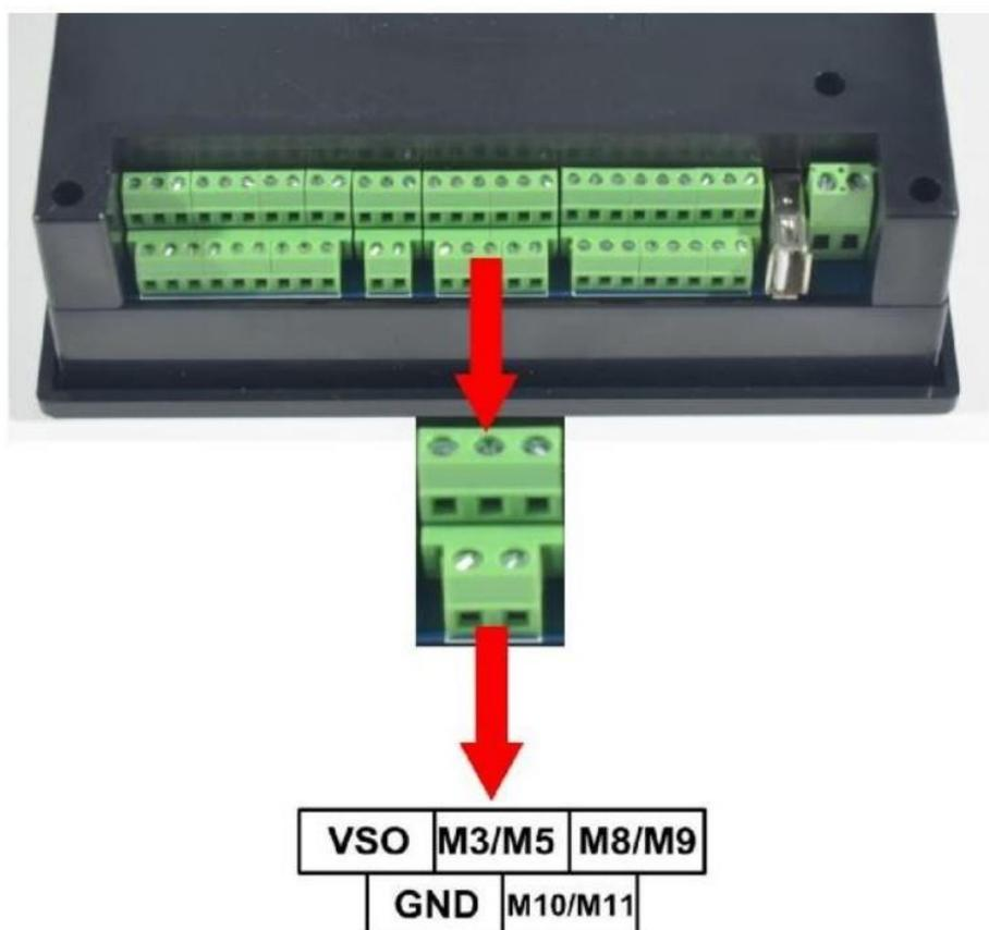
Рисунок 2-10. Интерфейс подключения шпинделя
