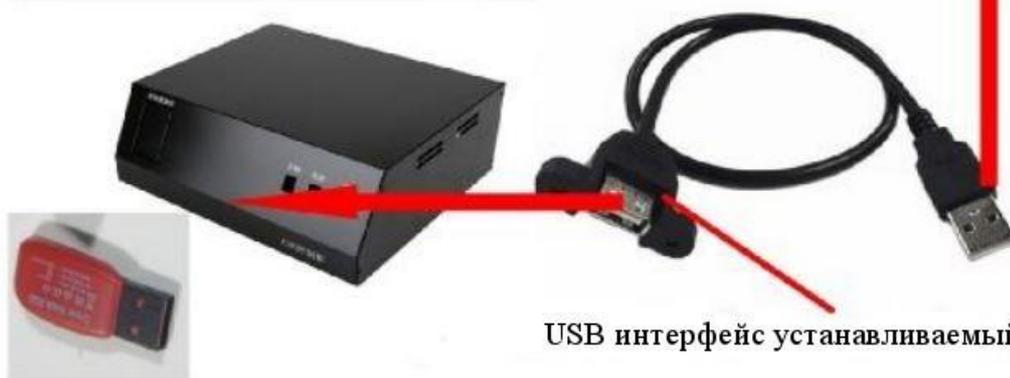
USB интерфейс устанавливаемый на панель
