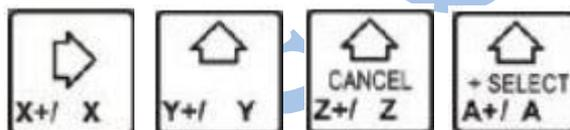
В: можно нажать любую из кнопок для обнуления координат по отдельным осям либо их перемещения к заданным координатам.
