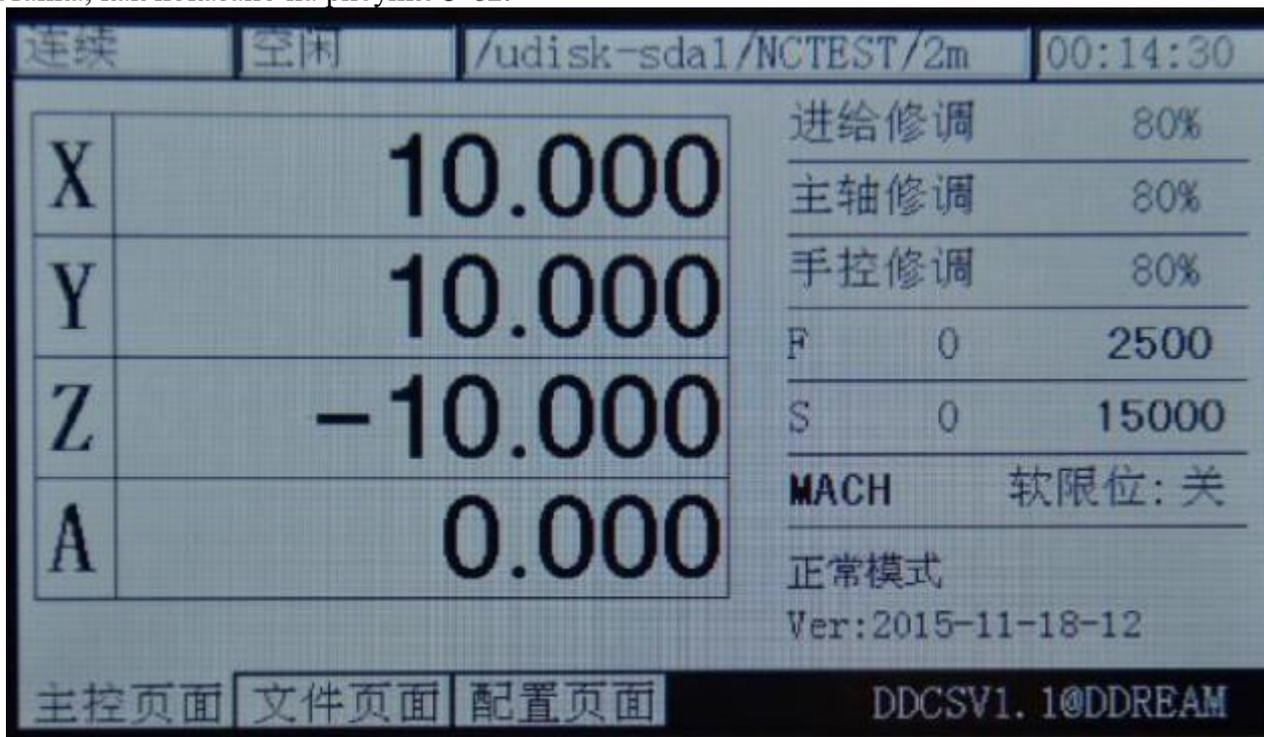
Рисунок 3-62. Переключение на систему координат станка
