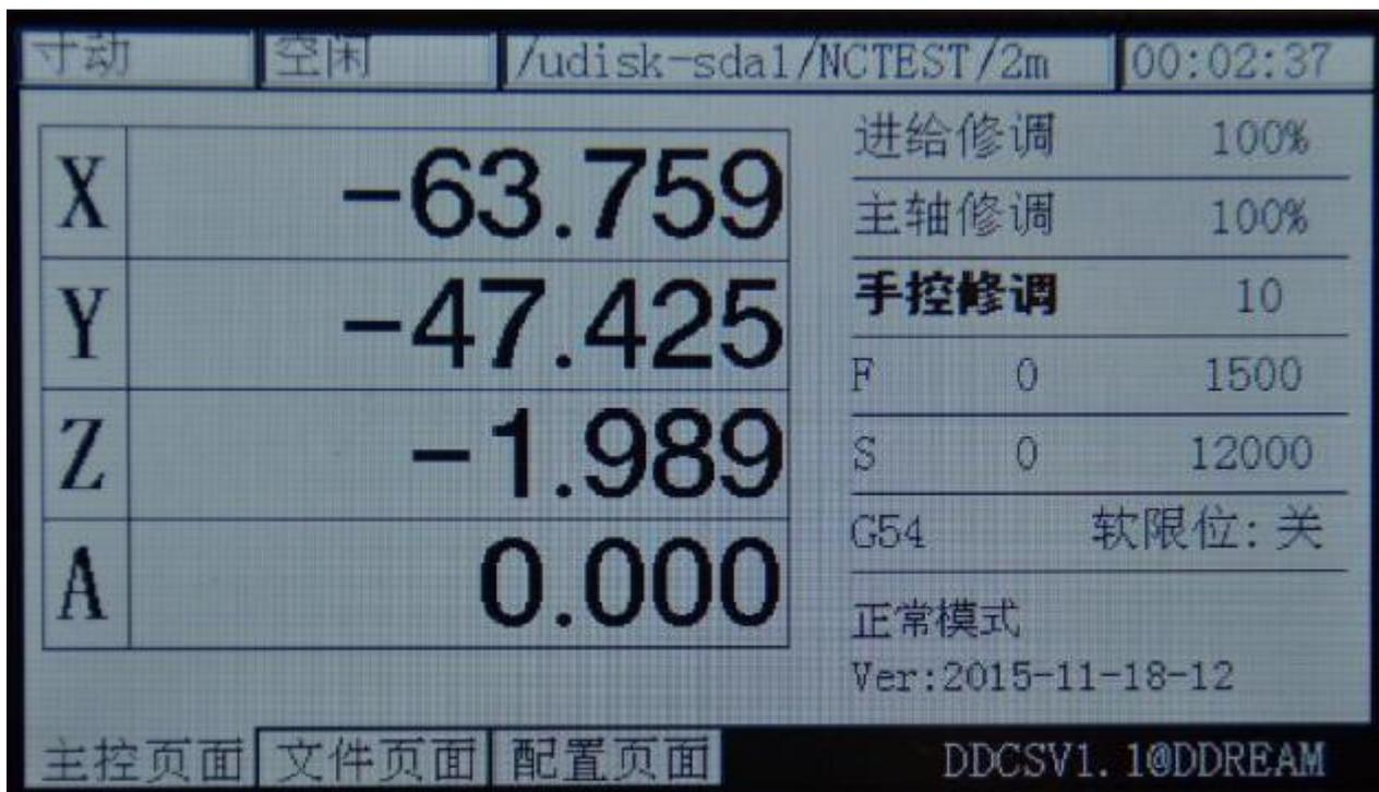
Рисунок 3-35. Применение SJR с установленным значением, равным 10
