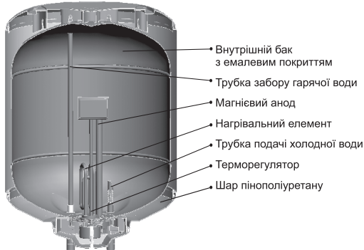
Рис. 1. ЕВАД ROUND в розрізі та його складові частини
