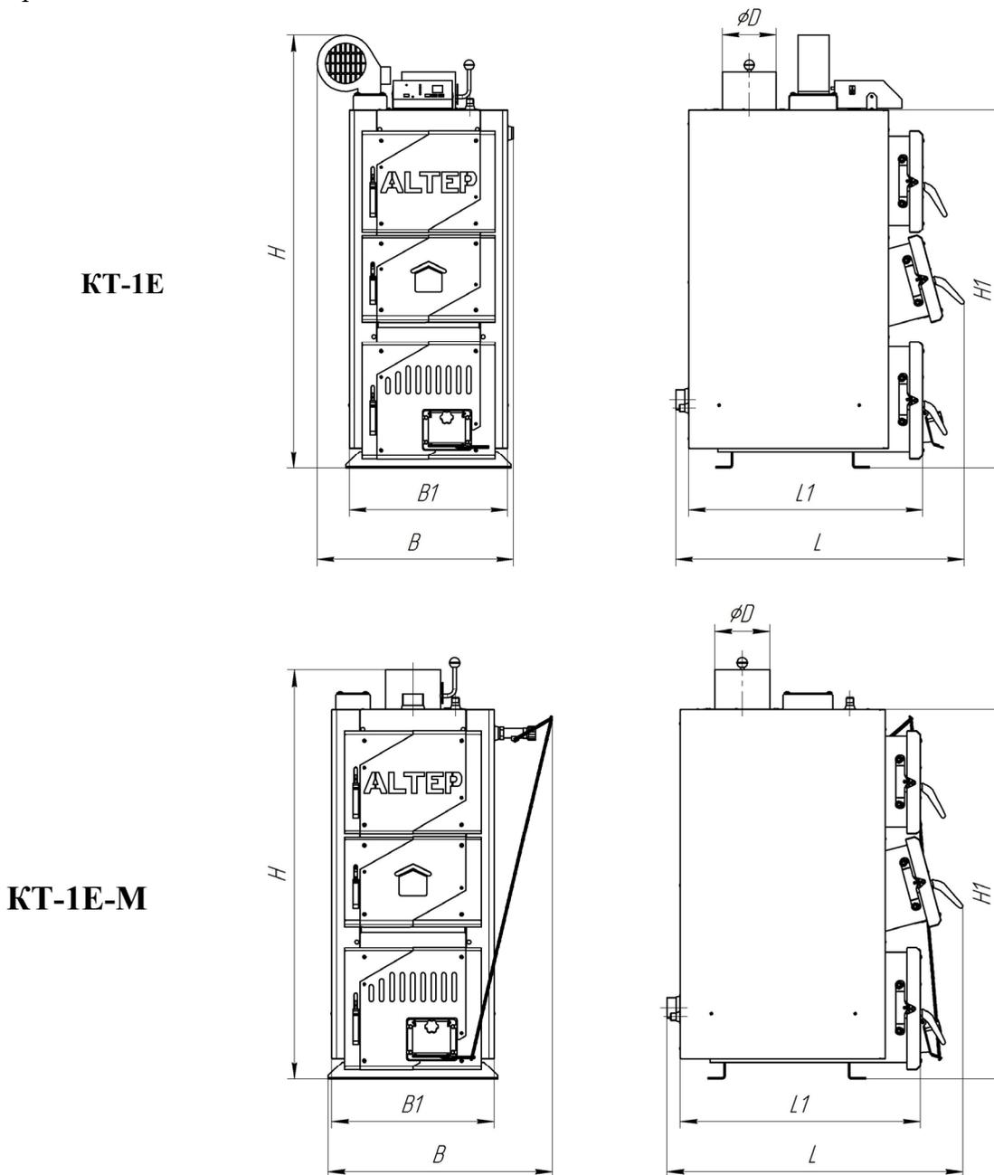
Рисунок 1 – Габаритный чертёж котла типа КТ-1Е (М)
