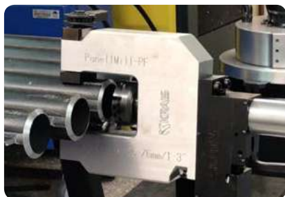
Удаление мембран на глубину 25 мм
