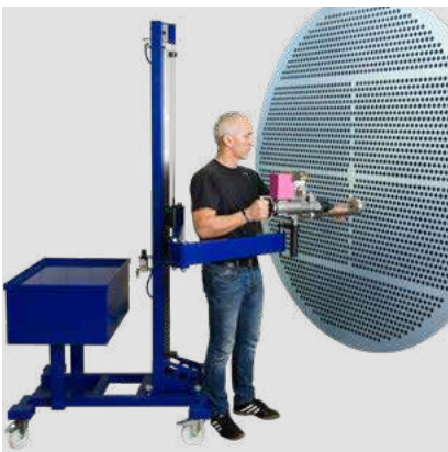
Auto K60 крепление на раме Flexpande
