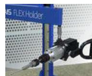
B1-B5 Серво привод (синхронный) под управлением TES1000
