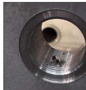
Могут обрабатываться все типы материалов для водоохлаждаемых с помощью карбидных резцов MiniMill 300 GFF.
