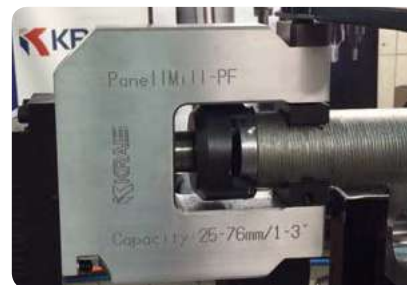
Удаление покрытия на глубину 25 мм
