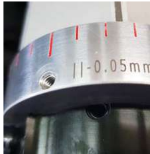
Настройка инструмента до желаемой глубины резания.
