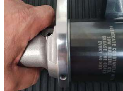
Защита рук от случайного удара вращающейся головки.
