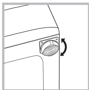
Належне вирівнювання надає стабільність машині та запобігає вібрації, шуму та пересуванню під час роботи. При встановленні машини на килимовому покрівлі або килимі відрегулюйте ніжки таким чином, щоб залишити під пральною машиною достатній простір для вентиляції.
