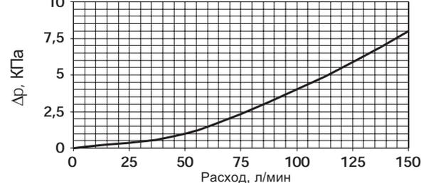
Зависимость потерь давления от расхода для головки сливного фильтра
