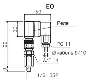
Индикатор для сливного фильтра MPS 100-150 (только для G1)
