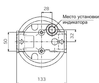
Индикатор для всасывающего фильтра MPS 100-150 (только для G1)
