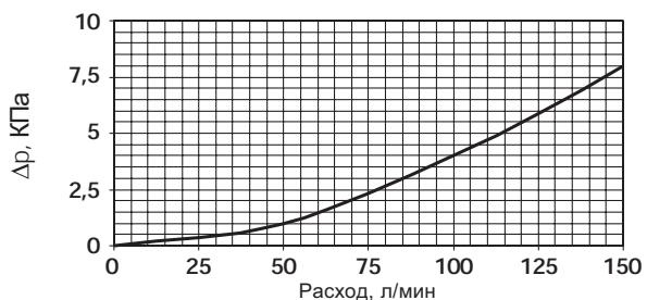
Зависимость потерь давления от расхода для головки сливного фильтра
