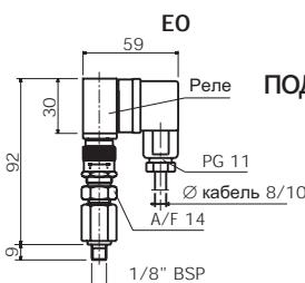
**Индикатор для сливного фильтра MPS 300-350 (только для G1-F1)**
