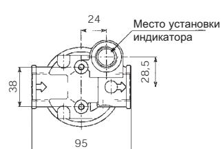
**Индикатор для всасывающего фильтра MPS 050-070 (только для G1-G5)**
