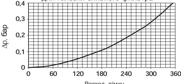
**Индикатор для всасывающего фильтра MPS 300-350 (только для G1-F1)**
