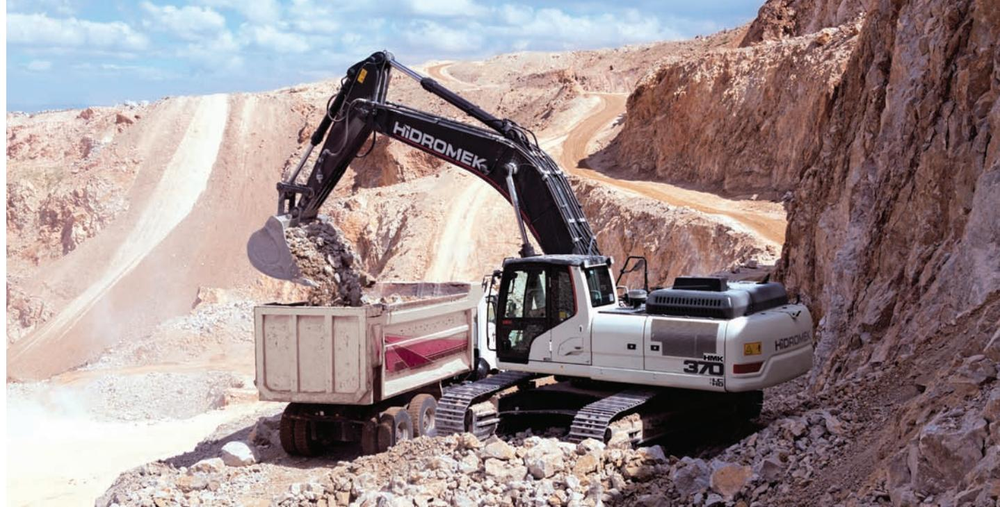
вращения поворотной части обеспечивается автоматически гидрораспределителем. Тем самым повышается эффективность. Система рекуперации предотвращает кавитацию во время движений стрелы, рукояти и ковша, и способствует увеличению срока службы гидросистемы и увеличению скорости передвижения машины.
