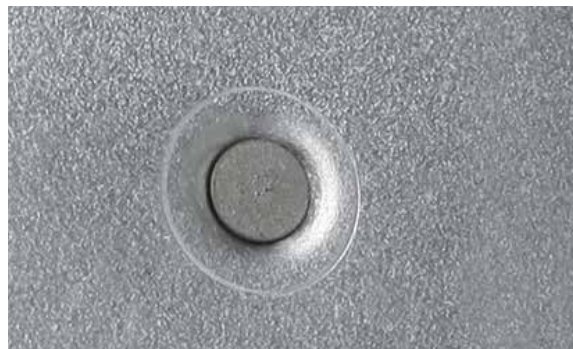
РЕЗУЛЬТАТ УСТАНОВКИ САМОПРОНИКАЮЩЕЙ ЗАКЛЕПКИ
