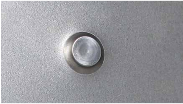
ABBILDUNG STANZNIETVERBINDUNG VORDER- U. RÜCKSEITE
