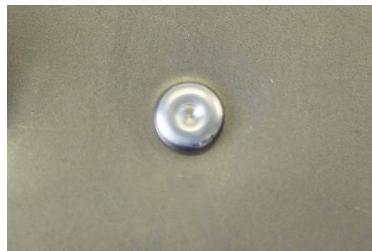
РЕЗУЛЬТАТ УСТАНОВКИ ЗАКЛЕПКИ ТЕКУЩЕЙ ФОРМЫ FLOW-FORM
