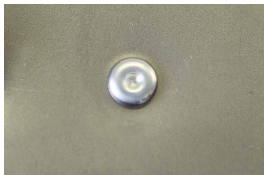
RESULTAAT VAN EEN FLOW FORM PONSNAGELVERBINDING.
