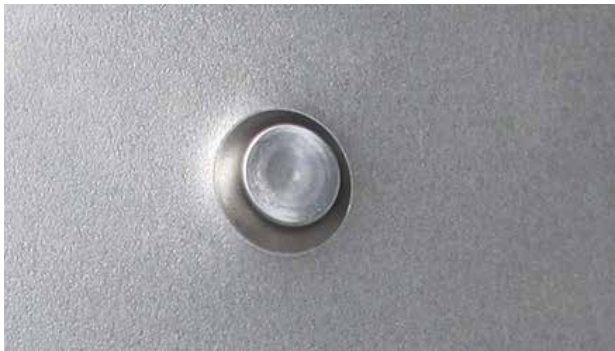
AFBEELDING PONSNAGEL VERBINDING VOOR- EN ACHTER-ZIJDE
