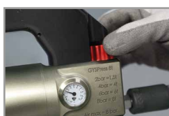
Настройка давления от 0 > 8 бар
