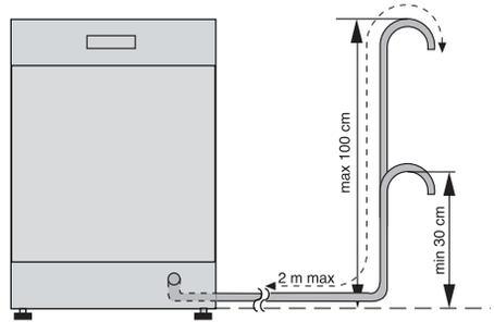
Аналогично, внутренний диаметр муфт, используемых для подсоединения к стоку, должен быть не меньше диаметра используемого шланга.
