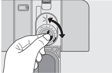
Дозировка установлена заводом-изготовителем в положение 4.
