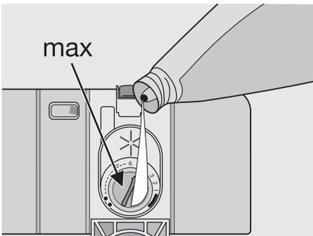
Дозатор вмещает примерно 110 мл ополаскивателя, которого, в зависимости от установленной дозировки, хватает на 16-40 циклов мойки посуды.
