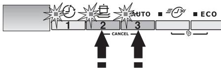
3. Нажмите кнопку 3, индикаторы кнопок 1 и 2 погаснут, а индикатор кнопки 3 будет продолжать мигать. Текущая установка отображается на цифровом дисплее.
