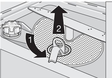
4. Взявшись за ручку с отверстием, извлеките фильтр грубой очистки (А) из микрофильтра (В).
