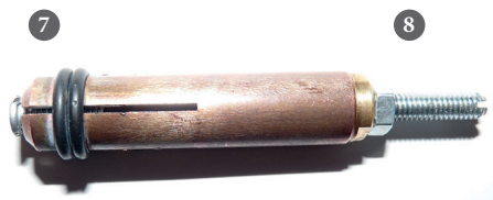
Медный наконечник с 4 прорезами для приваривания шпилек М4 (диаметр Ø 4 мм)
