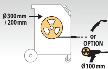
**Адаптируемый:** аппарат M1 GYS AUTO может комплектоваться горелкой Spool Gun. Эта приводная горелка имеет кассету для катушек Ø 100 мм алюминиевой, медной, стальной проволоки и проволоки из нержавейки Ø 0,8 мм.
