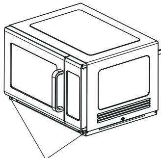
Потяните к себе и снимите заглушку с пластиковых гвоздиков, крепящих фильтр.
