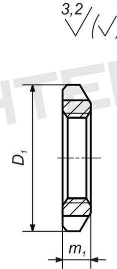
\* Допускается вместо фаски скругление радиусом ГОСТ 11871-88 Гайки круглые шлицевые класса точности А. Технические условия и отсутствие фаски для исполнения 2.
