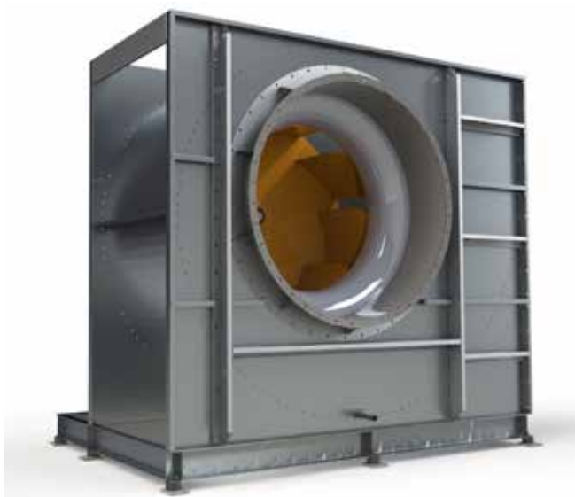
Радиальный вентилятор Расход воздуха до 160.000 м 3 /ч стат. перепад давления до 3.000 Па
