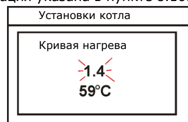
Рис 47 Выбор кривой нагрева котла, где: 1,4 - выбранная кривая нагрева, 59 - расчетная температура с кривой нагрева для актуально измеренной, датчиком СТ4-Р, внешней температуры.
