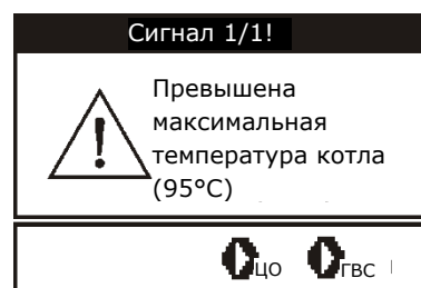
Рис 50 Вид сигнала "перегрев максимальной температуры котла"
