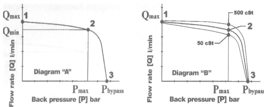
В точке 1- насос практически не испытывает никакого противодавления, следовательно, объем прокачки максимальен( $Q_{max}$ ).
