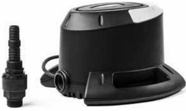
Автоматический погружной насос оснащен специальной опорой, обеспечивающей повышенную устойчивость и возможность работы в наклонном положении. Предназначен для откачивания дождевой воды с защитных тентов бассейнов в холодное время года и предотвращения повреждения тента под тяжестью скопившейся воды. Насос изготовлен из прочного термопластика. Электродвигатель, вал, крепежные болты и винты выполнены из нержавеющей стали.
