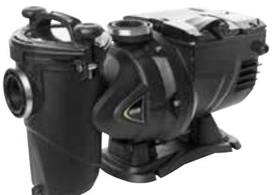
Насосы со встроенным префильтром с электронным управлением для бассейнов идеально подходят для циркуляции и фильтрации воды в плавательных бассейнах. Технология частотного преобразователя в сочетании с энергоэффективным синхронным электродвигателем с постоянно встроенными магнитами в роторе, охлаждаемым перекачиваемой жидкостью, обеспечивает минимальное энергопотребление и низкий уровень шума.
