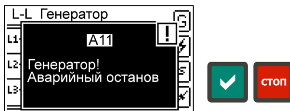
Рис. 5.23. Пример индикации тревоги A11
