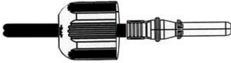
Малюнок 3-17 Закріплення металевої клеми
