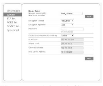
(4) Конфигурирование адреса настройки: войдите в рабочий интерфейс оборудования, задайте контактный адрес подключенного оборудования.
