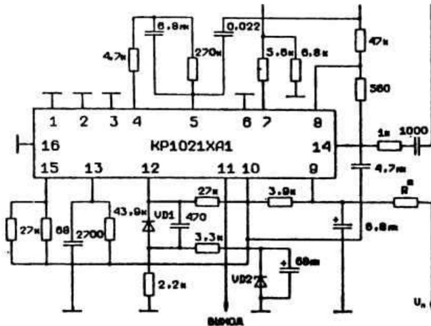
Схема включения КР1021ХА1 с принудительной синхронизацией:
