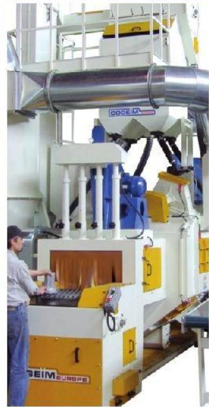
Особенностью установки является большая производительность. Однако этот тип дробеметов ограничен в максимальном весе обрабатываемых деталей.
