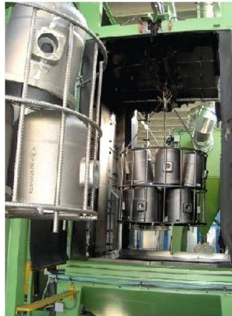
Дробеметная камера с автоматическим замкнутым конвейером GSA представляет собой подвесную установку проходного автоматического типа.
