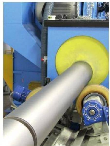
Дробеметные установки GRB разработаны и производятся для очистки труб и металлических изделий цилиндрической формы. GRB – установки проходного ролгангового типа.
