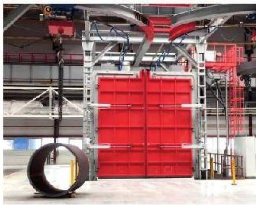
Система подачи заготовок в данных установках реализована при помощи двух крюков, перемещаемых по монорельсовой системе «У» типа, расположенной в верхней части дробемета.
