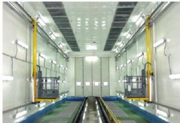
Дробеструйная камера – это устройство, предназначенное для очистки изделий из металла при помощи дроби или иного абразивного материала, который подается под высоким давлением со значительной скоростью на поверхность очищаемого изделия. Также может применяться для качественной очистки и обработки древесины, пластика, матирования стекла.
