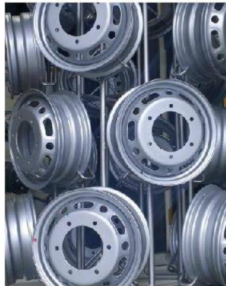
Установки GSA являются наиболее производительными установками, сохранившими при этом свою универсальность. Система подвешивания заготовки даёт универсальность а автоматический цикл – производительность.
