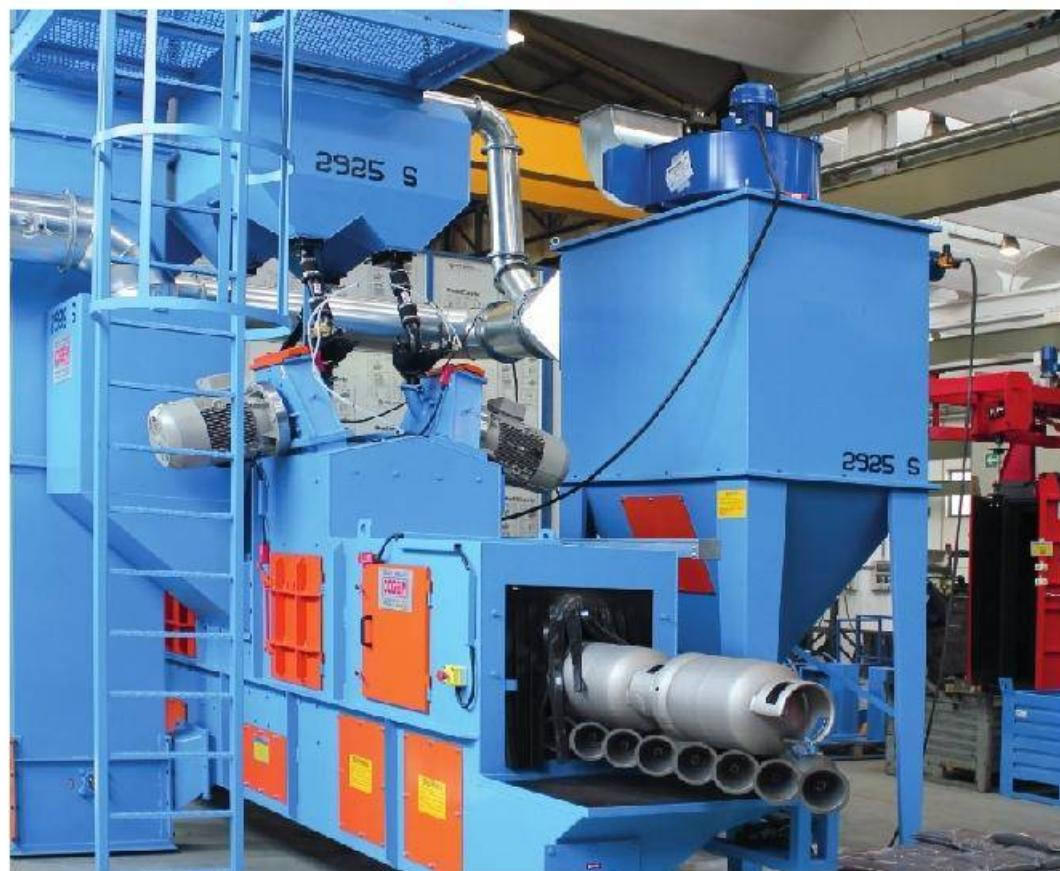
Данные установки могут работать как отдельно стоящими автоматическими дробеметными установками, так могут интегрироваться в уже готовые автоматические производственные линии заказчика.
