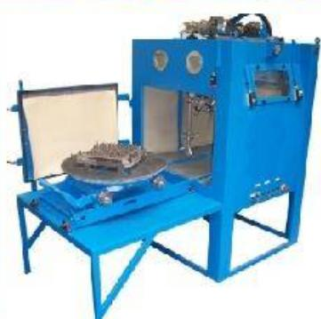
В качестве абразива может быть использован различный материал, предназначенный для многократного использования: стальная дробь, корунд, шлак, стеклошарики и т. д. Существуют также автоматизированные кабинеты для мелкосерийного производства. Имеется возможность изготовления оборудования практически любых размеров.
