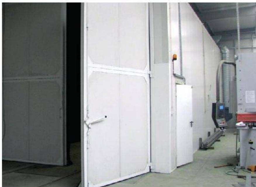
В процессе работы происходит устранение остатков формовочной смеси, следов ржавчины, производится зачистка сварочных швов, удаление окалины после термической обработки.
