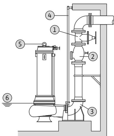
Fig. 8: Стационарная установка в погруженном состоянии
