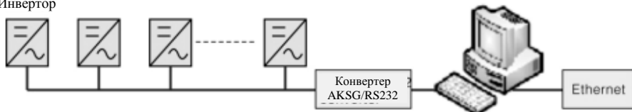
Рисунок 9 – ПК осуществляет мониторинг через интерфейс AKSG
