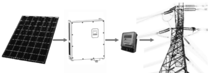
Рисунок 1- Использование фотоэлектрического инвертора, соединенного с электрической сетью в системе производства электроэнергии с использованием фотоэлектрического источника.
