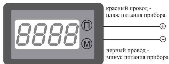
Рис.1. Подключение прибора. Допустимо питание как постоянным, так и переменным током.
