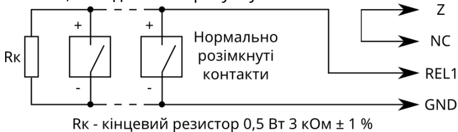
Рисунок 2.5 – Схема включення двопровідних сповіщувачів з нормально розімкнутими контактами
