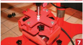
7. Кладем на нижнюю «подушку» кепочный нагревательный элемент с креплением. Опускаем рычаг и фиксируем гайками: Подключаем нагревательный элемент к блоку управления.
