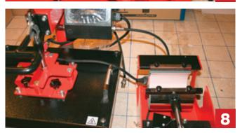
8. Для подключения кружечного нагревательного элемента необходимо отсоединить штекеры концевого выключателя (таймера) и установленного нагревательного элемента. Затем, в соответствующие разъемы на блоке управления, подсоединить штекер кружечного нагревательного элемента и штекер концевого выключателя (таймера) кружечной станины.
