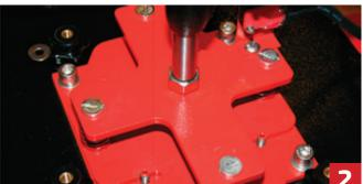
1,2. Для замены нагревательной плиты необходимо открутить 4 фиксирующие гайки, в народе называющиеся «барашки». Поднимаем рычаг и аккуратно убираем плиту в сторону.
