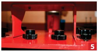
5. Для установки кепочного нагревательного элемента необходимо снять верхнюю нагревательную плиту или тарелочный нагревательный элемент. Затем открутить 2 гайки фиксирующие нижний стол.
