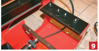
9. Для смены нагревательного элемента в кружечной станине откручиваем 4 фиксирующих винта и аккуратно извлекаем нагревательный элемент.
