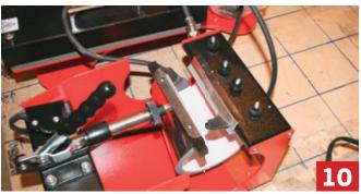
10, 11. Аккуратно вставляем необходимый нагревательный элемент и фиксируем гайками. Затем подключаем элемент и концевой выключатель в соответствующие разъемы на блоке управления.
