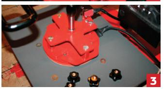
3. Затем кладем тарелочный нагревательный элемент на стол и опускаем рычаг.
