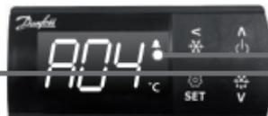
Коды температуры и тревожной сигнализации поочередно мигают до тех пор, пока сигнал тревоги не устранен. Отображается сигнальный звонок.
