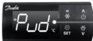
"Pud": отображается в течение 3 секунд для индикации захлаживания.
