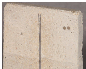
Соединение двух пластин AQUAFIN-CJ5 внутри секции бетона
