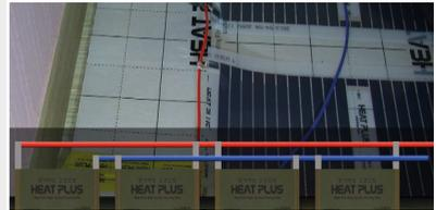
Подключить провода к коннекторам, которые установлены на пленке, либо подключение проводов произвести методом пайки к медным шинам пленки и вывести к терморегулятору так, как указано на схеме, с учетом максимальной нагрузки.
