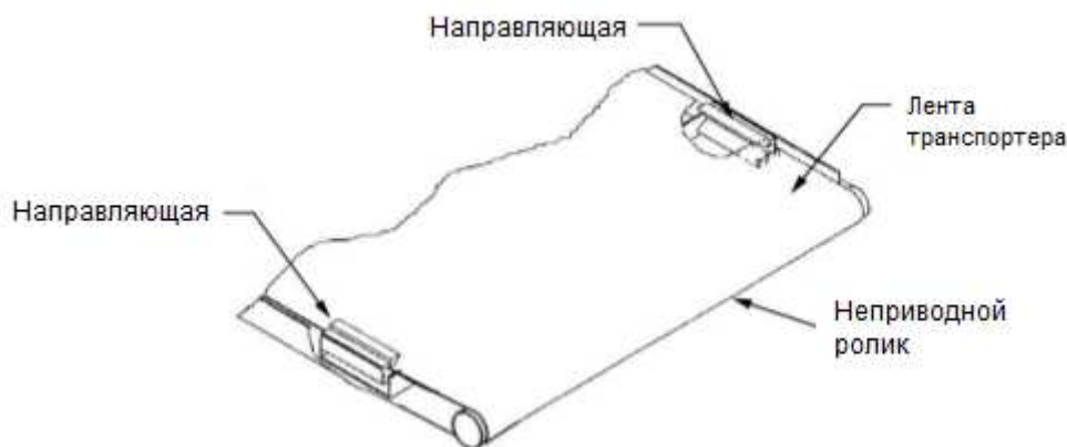
Рис. 22 – Показана обратная сторона транспортера
