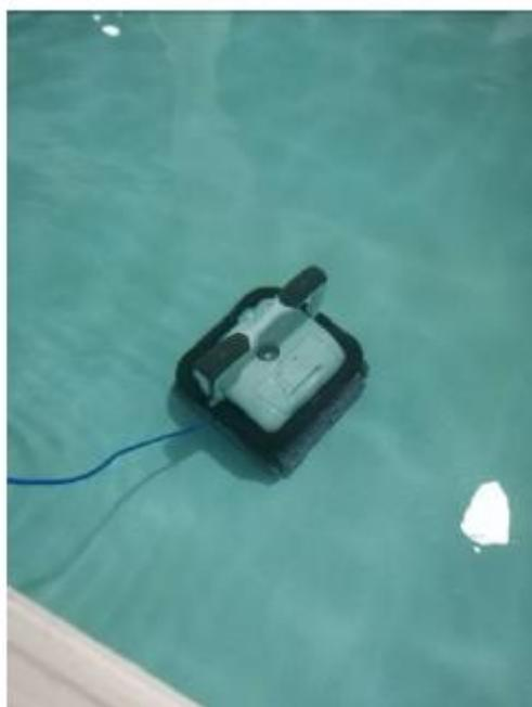
При вытягивании робота из воды подержите его над водой примерно на 10 — 15 секунд, чтобы вытекла вода из корпуса. Пожалуйста, держите робот за верхнюю ручку, никогда не тяните его за кабель.
