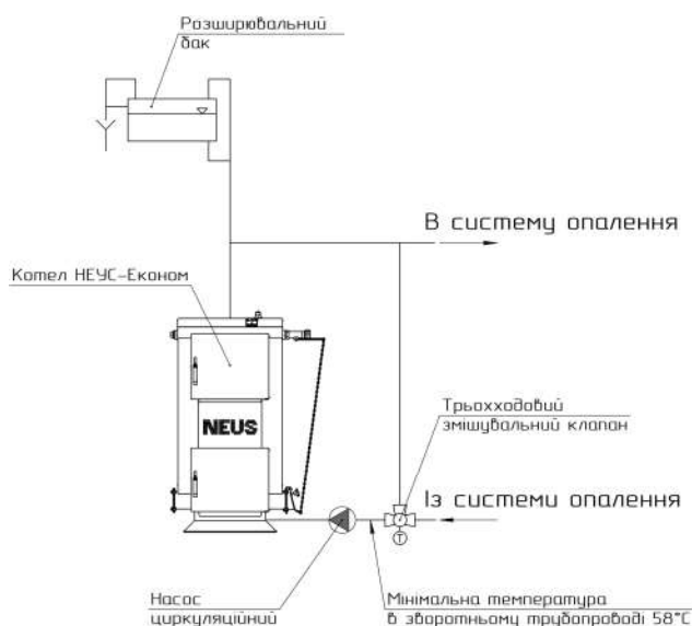
Рисунку 3 – Схема підключення котла до системи опалення
