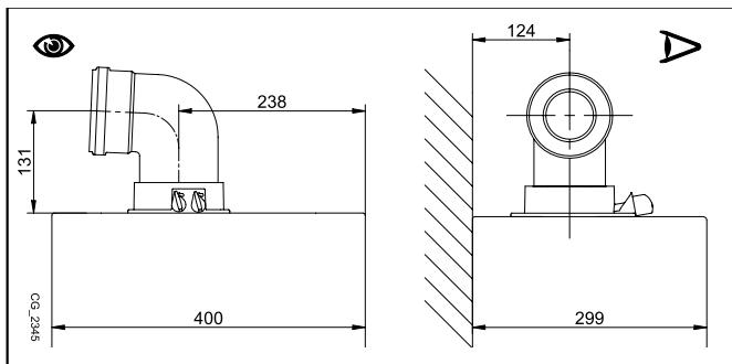
• 90° відвід скорочує можливу повну довжину труби на 1 метр.
