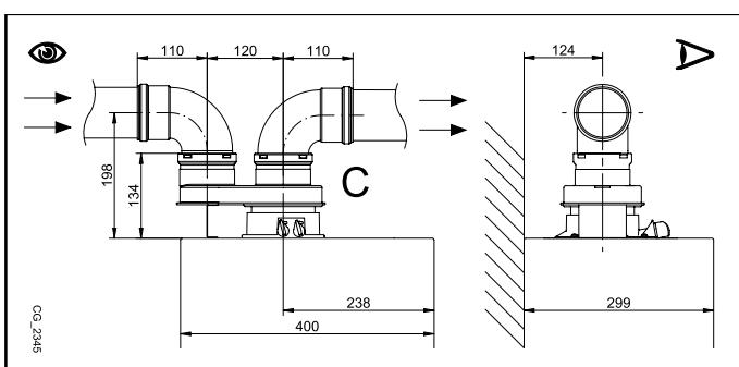
90° відвід дозволяє приєднувати котел до димоходу-повітроводу в будь-якому напрямку, адаптуючись до різних потреб. Крім того, він може використовуватися в якості додаткового в поєданні з трубою з 45° відвідом.
