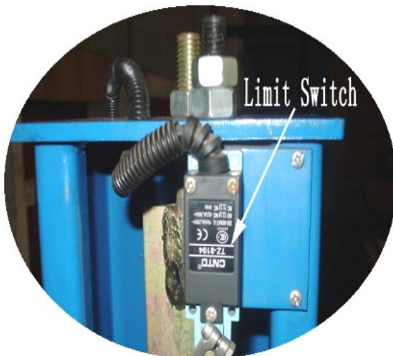
Рис.15. Ограничитель высоты подъема
