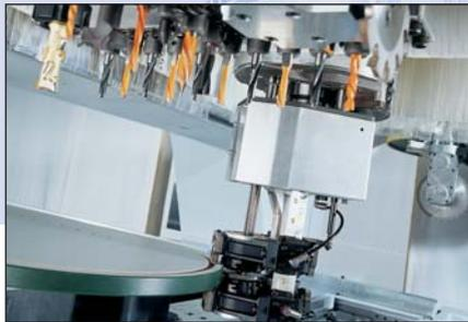
Erstklassige Ergebnisse – für bestechende Kantenoptik sorgt das getastete Kombi-Bündigräs-Nachputzaggregat, das den Antrieb, die C-Achse sowie die Pneumatik verwendet. Auch hier handelt es sich um patentierte HOMAG Technik
