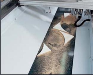
Hochsteifes Maschinenbett mit integrierter Reststückentsorgung über die gesamte Bearbeitungstiefe von 1.300 (Venture 20) bzw. 1.600 mm (Venure 22). Es fallen keine Reststücke vor die Maschine (optional mit Spänetransportband)
