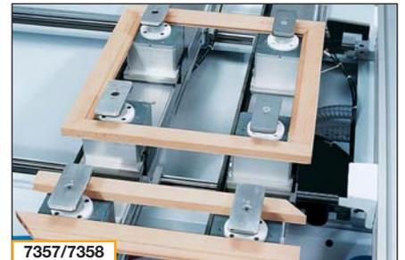
Schlauchlose Vakuumspanner für Rahmenteile
