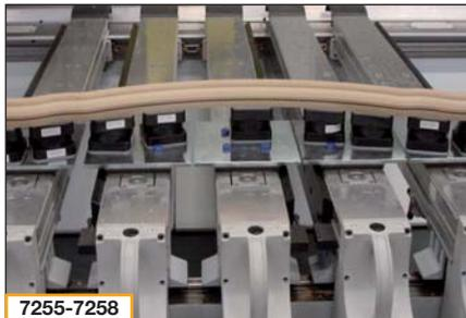
Maxi-Flex-Spannsystem für die flexible Aufspannung von Formteilen
