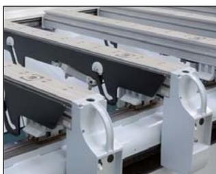
Robuste Einlegehilfen zur Auflage schwerer Werkstücke
