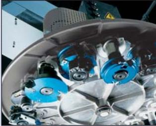
Schneller Tellerwechsler mit 12 großen Plätzen für Werkzeuge und Aggregate mit einem Durchmesser von bis zu 180 mm
