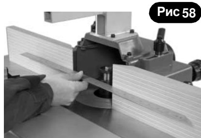
Приложите линейку к упору и проверьте, расположение его частей вдоль одной прямой
