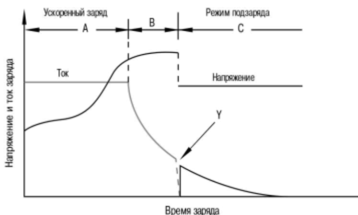
Рис. 4. Зарядные характеристики при использовании двухступенчатого заряда постоянным напряжением
