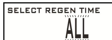
Нажмите кнопку «NEXT» и выберите «NOW», чтобы провести регенерацию немедленно, или «DELAYED», чтобы провести регенерацию в установленное для отложенной регенерации время (время отложенной регенерации задается на *Шаге 5SS*)
