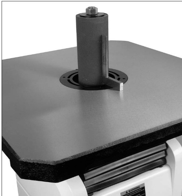
Рис. 13: настройка упора наклона стола
