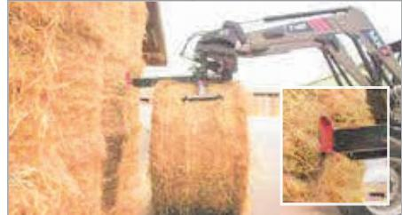
Опустив захват в нижнее положение, нажмите кнопку толкателя и освободите захват.
