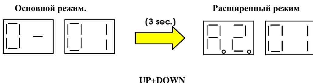
**Основной режим** обеспечивает настройку минимального числа параметров необходимых для работоспособности системы.
