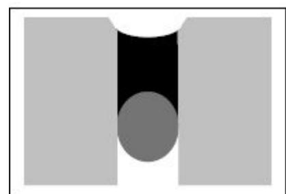
Конструкция шва заподлицо исключает помехи движению и скопления грязи.
