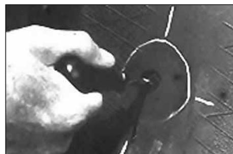
12. Нанесите клей №760 (Chemical Vulcanizing Fluid) внутрь прокола по всей его длине с помощью спирального шила № 915 (Spiral Cement Tool), поворачивая шило по часовой стрелке. Повторите эту процедуру от 3 до 5 раз. Оставьте шило в проколе до тех пор, пока не перейдете к выполнению пункта 15.
