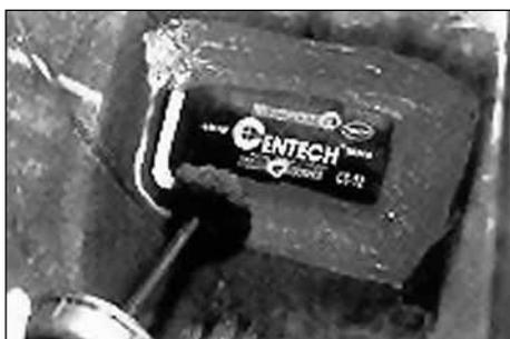
28. При ремонте бескамерной шины нанесите внутрискоронный уплотнитель № 738 (Security Coat) по периметру пластыря и на оставшуюся обработанную поверхность. Если ремонтируете камерную шину, нанесите на отремонтированное место тальк No 706 (Tire Talk). Это предотвратит слипание серого слоя на краях пластыря и камеры.
