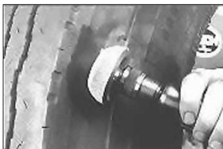
54. Обработайте снаружи место ремонта шины мелкозернистым шлифовальным кругом S2032 совместно с полиуретановой вставкой S2033. Скорость вращения шероховальной машинки при обработке не должна превышать 5000 об/мин. Обработку следует производить в направлении от центра повреждения к краям до получения ровной поверхности. Эта операция носит косметический характер.
