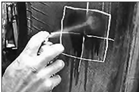
8. Нанесите аэрозольный очиститель-обезжириватель № 704 (Rub-O-Matic) на отмеченную область шины.
