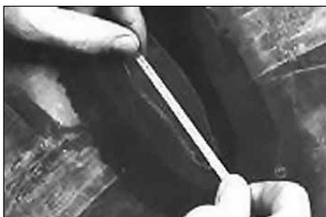
20. Измерьте поврежденное место после обработки, чтобы определить необходимый размер пластыря ВР. Определите количество слоев корда в шине. Используйте таблицу выбора диагональных пластырей ВР. Не измеряйте глубину повреждения под углом 45°.
