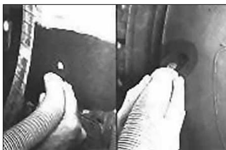
29. Очистите пылесосом обработанную область для удаления металлической стружки, мелких частиц резины и резиновой пыли. Можно очистить место повреждения мягкой металлической щеткой S 892 на низкооборотной машинке с последующей очисткой пылесосом.
