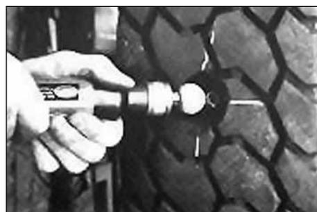
12. Для получения необходимой текстуры, обработайте повреждение с внешней стороны шины с помощью шероховального шарика RUBBERHOG RH-551 с зернистостью 230SSG на низкооборотной пневмошеровальной машинке S-1036 (максимальная скорость вращения 5000 об/мин) или S-1032 (максимальная скорость вращения 2500 об/мин). Держите шарик под углом 45°.
