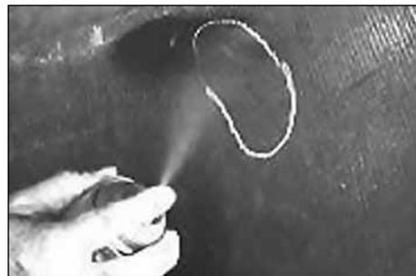
7. Определите, что шина подлежит ремонту, очистите внутреннюю поверхность шины. Нанесите аэрозольный очиститель-обезжириватель № 704 (Rub-O-Matic) на поврежденную область шины.
