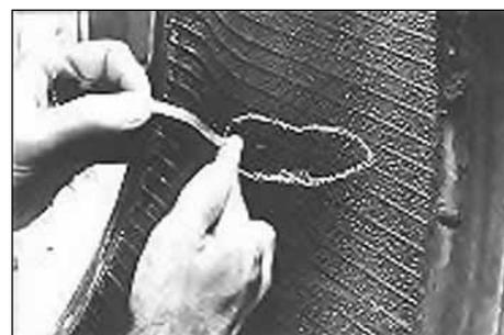
4. Измерьте расстояние между краем борта шины и краем повреждения. Для определения области, не подлежащей ремонту. Повреждение не должно выходить за рамки неремонтируемой области, А-В
