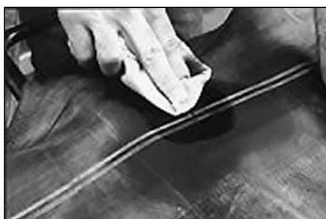
5. Очистите ремонтируемую область с помощью очистителя-обезжиривателя № 704 (Rub-O-Matic) и ткани, не содержащей ворс.
