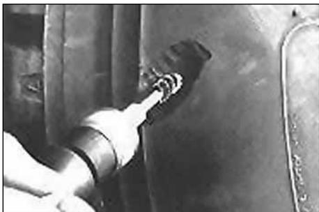
16. Обработайте края пореза внутри шины с помощью металлической щетки S-892 и низкооборотной пневмошероховальной машинки S1032 или S1036, чтобы придать им необходимую шероховатую текстуру. Не используйте высокооборотный инструмент, так как возможно подгорание резины.
