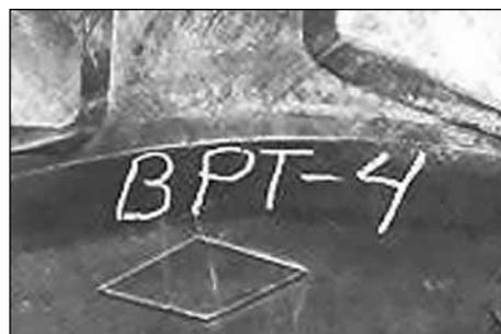
22. Напишите размер и тип выбранного пластыря снаружи на шине.
