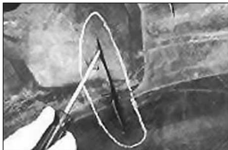
5. Удалите из шины все инородные предметы. Определите размер повреждения и возможное расслоение слоев корда с помощью спирального шила с тупым концом № 915 или № 918 изнутри и снаружи шины.
