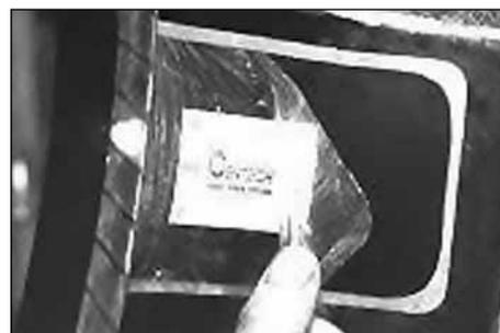
38. Удалите прозрачную полиэтиленовую пленку с пластыря.
