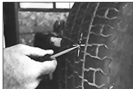
4. Исследуйте повреждение с внешней и внутренней стороны шины с помощью спирального шила № 915 (Spiral Cement Tool).
