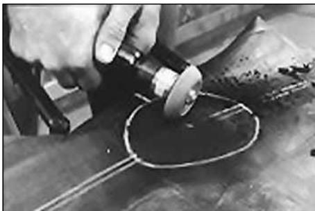
8. Обработайте ремонтируемую область механически. Это необходимо для удаления технологических неровностей и верхнего слоя поверхности камеры. Скорость вращения пневмощероховальной машинки при обработке не должна превышать 5000 об/мин. Используйте шлифовальный круг S2032 совместно с полиуретановой вставкой S2033.
