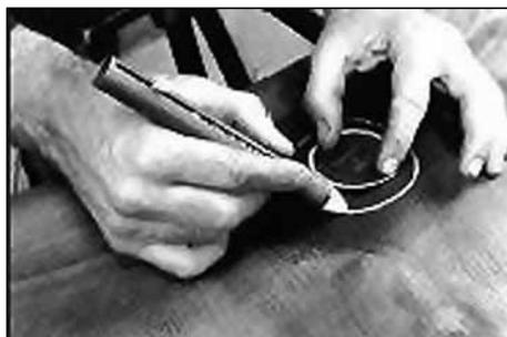
5. Приложите латку по центру повреждения и отметьте вокруг нее область на 15 мм больше размера латки для механической обработки камеры.
