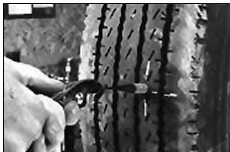
23. После снятия проволочного держателя с ножки грибка, снова проверьте направления стрелки к ободу. Вытягивайте грибок плоскогубцами, пока он не встанет на место.
