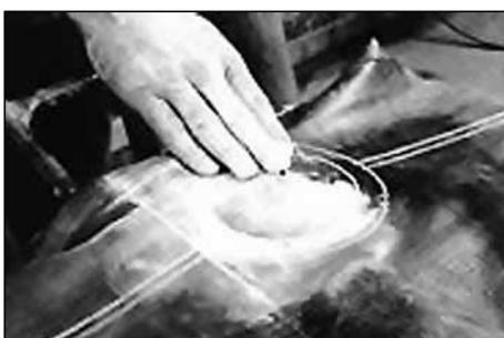
14. Удалите прозрачную полиэтиленовую пленку с подложки и нанесите на отремонтированное место тальк № 706 (Tire Talc). Это предотвратит прилипание серого слоя подложки к внутренней поверхности шины.
