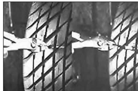
18. Зажмите плоскогубцами металлический держатель с внешней стороны шины и вытяните ножку грибка. Если металлический держатель отделится от ножки, когда она выйдет из прокола, зажмите ее плоскогубцами и тяните до полной установки грибка.
