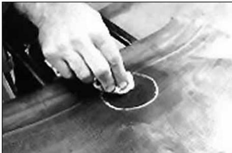
7. После механической обработки (шороховки камеры), нанесите на ткань очиститель-обезжириватель № 704 (Rub-O-Matic) и обработайте место повреждения, двигаясь от центра ремонтируемой области к краям. Повторите эту процедуру столько раз, сколько требуется для качественной очистки ремонтируемой поверхности. Дайте очистителю-обезжиривателю 3-4 минуты для полного высыхания.
