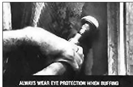
41. Обработайте отмеченную область до ровной поверхности мелкозернистым контурным кругом RH-106 совместно с полиуретановой вставкой RH-152. Скорость вращения пневмошеровальной машинки S-1036 при обработке не должна превышать 5000 об/мин. Это необходимо для увеличения площади соприкосновения пластыря с шиной.
