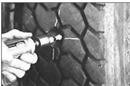
10. Используя шлифовальный конус из оксида алюминия S-872 на высокооборотной пневмошеровальной машинке S-1034 или S-1039 (при минимальной скорости вращения 20000 оборотов в минуту), обработайте все распутившиеся нити стального корда до самой резины в месте повреждения. При этом действуйте с перерывами, чтобы не произошло пережигания резины.
