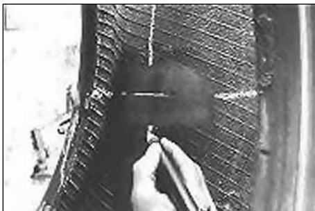
26. Обозначьте место повреждения шины с внешней и внутренней сторон с помощью маркировочного мела № 951. Проведите осевые линии по центру повреждения на внутренней стороне шины, чтобы легче можно было отцентрировать пластырь и вулканизатор.
