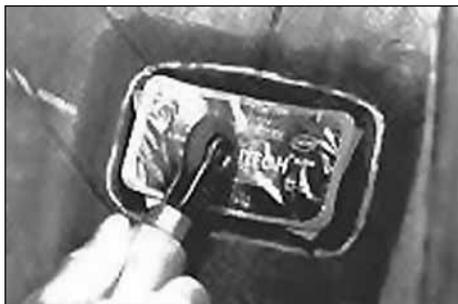
25. Тщательно прикатайте пластырь с помощью ролика закаточного № 936 (Stitcher) от центра к краям.
