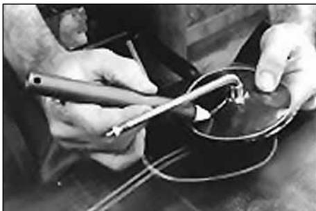
7. Плотно прикрутите новый вентиль к подложке и мелом отметьте на ней направление вентиля для правильной установки и предотвращения возможной утечки воздуха в дальнейшем.
