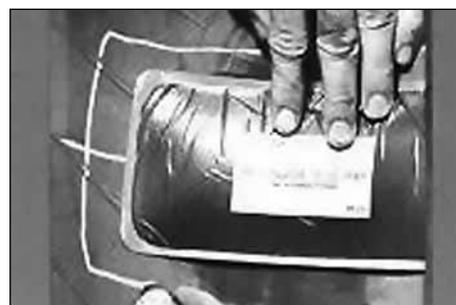
36. Используя проведённые Вами линии (смотри пункт 2), приложите пластырь, выбранный заранее (смотри пункт 19) на повреждение по центру. Обведите периметр пластыря маркировочным мелом № 951 примерно на 25 мм больше размеров пластыря. Это область для механической обработки контурным кругом.
