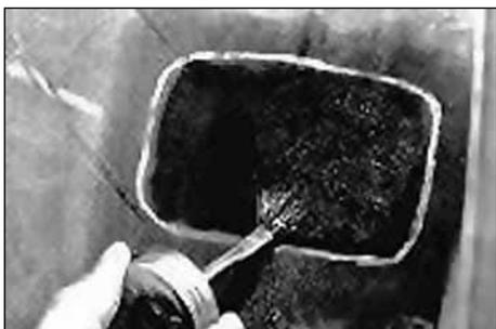
22. Нанесите тонкий слой вулканизационной жидкости No 760 (Chemical Vulcanizing Fluid) на обработанную поверхность. Дайте вулканизационной жидкости 3-4 минуты для полного высыхания.
