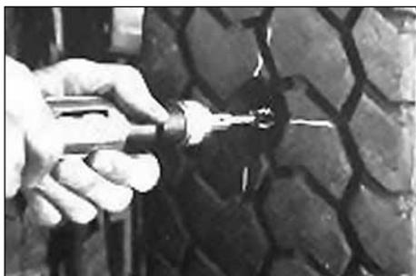
13. Обработайте края пореза внутри шины с помощью короткой металлической щётки S-892 и низкооборотной пневмошеровальной машинки S1032 или S1036, чтобы придать им необходимую шероховатую текстуру, так как при использовании инструмента на высокооборотной пневмошеровальной машинке происходит пригорание резины. Держите щетку под углом 90°.
