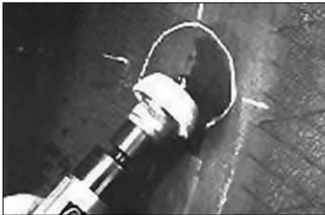
7. Обработайте отмеченную область абразивной полусферой RH104-RH-106 совместно с полиуретановой вставкой RH-152. Скорость вращения шероховального инструмента не должна превышать 5000 об/мин. (Используйте пневмошероховальную машинку S1036). При данной операции пользуйтесь защитными очками.
