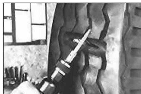
12. При обработке дорожек протектора, используйте абразивный карандаш RH-625 и низкооборотную пневмошеровальную машинку S-1036, для лучшего закрепления сырой резины при последующей вулканизации.
