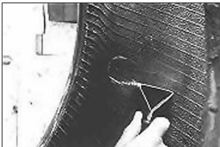
8. Пока отмеченная область еще влажная, удалите загрязняющие субстанции скребком № 933 (Rubber Scraper) (снаружи и внутри)
