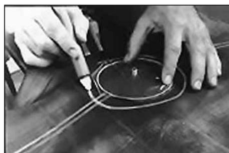
6. Приложите латку по центру отверстия и отметьте вокруг нее область на 15 мм больше для механической обработки камеры. Обозначьте на камере направление оригинального металлического вентиля для дальнейшего правильного монтажа камеры в обод.
