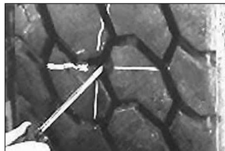
4. Определите размер повреждения и возможное расслоение корда с помощью спирального шила с тупым концом.
