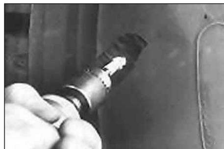
15. Если повреждено большое количество нитей металлокорда, для их обработки используйте бор-фрезу карбидную № 283, после чего зашлифуйте шлифовальным конусом из оксида алюминия S-872 на высокооборотной пневмошеровальной машинке S-1039 (при минимальной скорости вращения - 20000 об/мин).
