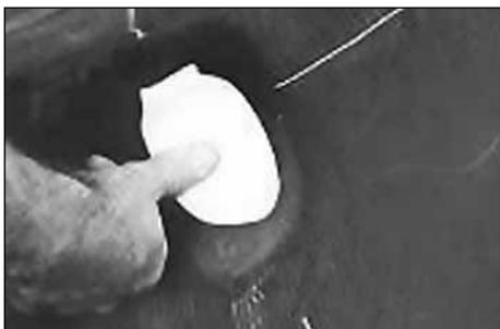
26. Вырежьте полоску сырой резины (Tech Vul-Gum) толщиной 3 мм и по ширине на 25 мм больше, чем размеры обработанного повреждения. Расположите полоску сырой резины с внутренней стороны шины таким образом, чтобы порез располагался строго по центру. Надавите на полоску сырой резины большим пальцем с внутренней стороны шины.
