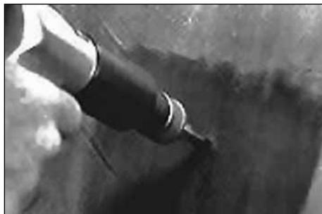
8. Подготовьте повреждение с помощью карбидной фрезы (Carbide Cutter). Скорость вращения дрели при обработке прокола не должна превышать 1200 об/мин. Используйте вращение по часовой стрелке. Обработайте прокол с внутренней стороны шины. Повторите эту процедуру, как минимум, трижды.
