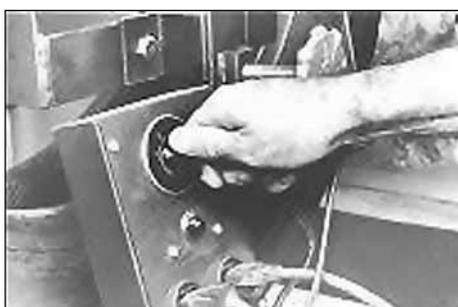
39. Установите таймер, используя расчётное время вулканизации.
