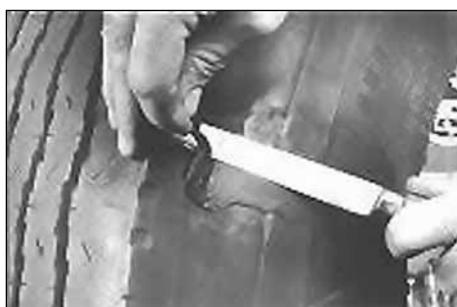
40. После окончания процесса вулканизации отсоедините линию подачи воздуха и снимите вулканизатор с шины. Дайте ей остыть, а затем, используя гибкий нож № 942 (Tech Flex Knife), отрежьте остатки резины.
