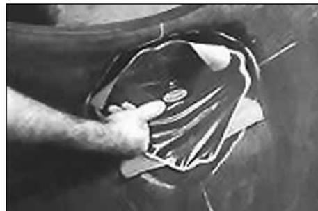
49. Отцентрируйте пластырь согласно вертикальной и горизонтальной линии, которые Вы провели от центра повреждения (см. пункт 17). Расположите пластырь строго по центру повреждения. Убедитесь в том, что стрелка на пластыре, указывающая направление корда, действительно направлена к борту шины. Это значит, что направление нитей корда в пластыре совпадает с направлением нитей корда в шине. Придавите середину пластыря большим пальцем.
