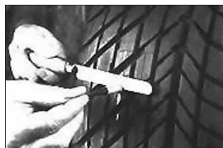
24. Отрежьте выступающую часть ножки грибка на 3 мм выше уровня поверхности шины. Ремонт завершен. Шина готова к эксплуатации.
