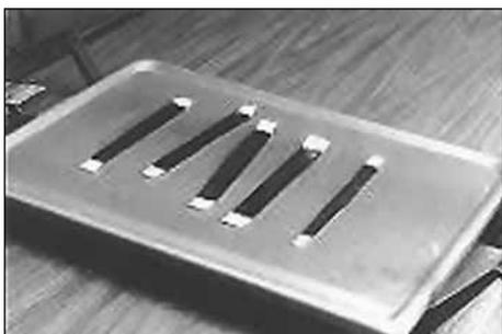
28. Нарезьте полоски резины для горячей вулканизации (Tech Vul-Gum) в количестве, достаточном для заполнения повреждения. Предварительно нагрейте резину до температуры 49°-55°С.
