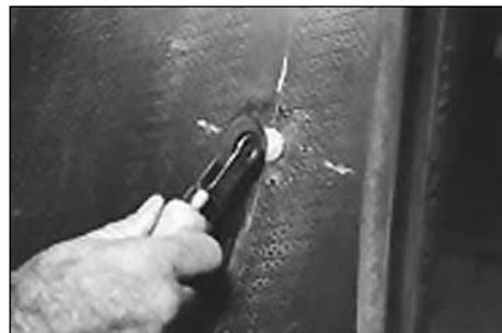
18. Тщательно прикатайте шляпку грибка с помощью раскатки № 936 (Stitcher) от центра к краям. Прижимайте раскатку достаточно сильно, чтобы обеспечить максимальное приклеивание шляпки грибка.
