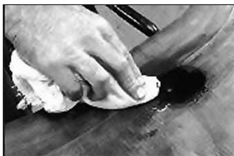
3. Очистите ремонтируемую область с помощью очистителя-обезжиривателя №704 (Rub-O-Matic) и ткани, не содержащей ворс.
