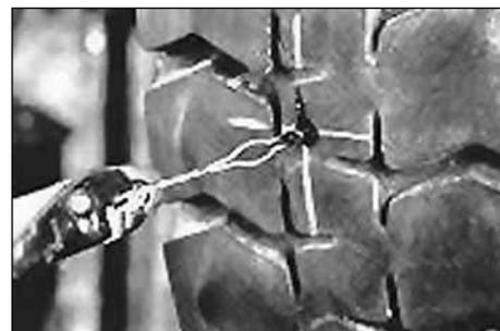
15. Зажмите плоскогубцами металлический держатель с внешней стороны шины и вытяните колышек.
