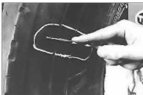
3. Исследуйте повреждение с внешней стороны шины. Определите с помощью спирального шила № 915, нет ли расслоения нити корда.
