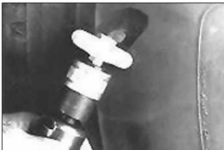
17. Обработайте поверхность пореза с помощью абразивного круга RH304 с зернистостью 230SSG и низкооборотной пневмошероховальной машинки S1036 (максимальная скорость вращения 5000 об/мин), расположив круг под углом 45° к повреждению. Это необходимо для придания шероховатости на внутренней поверхности пореза. Круг при обработке не должен соприкасаться с нитями металлокорда, чтобы не повредить их.
