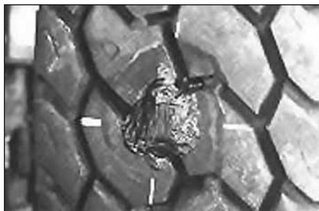
29. Порез должен быть заполнен сырой резиной так, чтобы она выступала на 6-9 мм над поверхностью шины. Самая большая толщина слоя сырой резины должна находиться по центру поврежденного места и уменьшаться к его краям.
