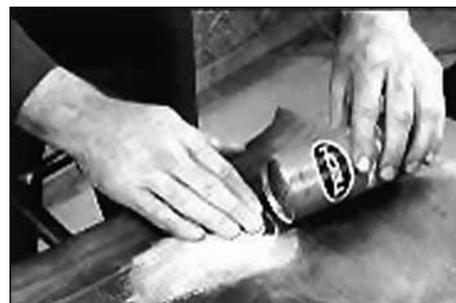
12. Удалите прозрачную полиэтиленовую пленку с латки и обработайте отремонтированное место тальком № 706 (Tire Talk). Это предотвратит прилипание серого слоя латки к внутренней стороне шины.
