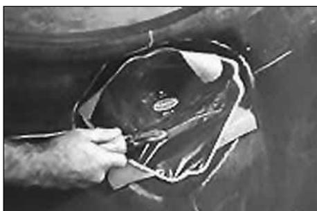
50. Тщательно прикатайте пластырь с помощью ролика закаточного № 936 (Stitcher) от центра к краям. Надавите на ролик для обеспечения более плотного прилегания пластыря к шине. Не должно оставаться никакого воздуха между пластырем и шиной.
