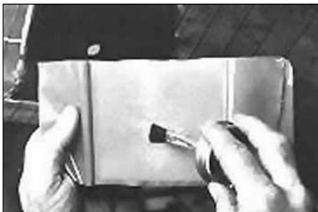
34. Нанесите тонкий, ровный слой вулканизационной жидкости № 760 (Chemical Vulcanizing Fluid) на серый слой пластыря, чтобы обеспечить качественное приклеивание к сырой резине в месте повреждения. Дайте жидкости примерно 3-4 минуты для полного высыхания.
