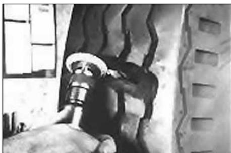
13. Обработайте повреждение под углом 45°, используя абразивный круг RH-304 с зернистостью 230 SSG и низкооборотную пневмошеровальную машинку S-1036. Процесс обработки резины в месте повреждения можно ускорить, используя абразивный круг RH-302 с большей зернистостью 390 SSG и низкооборотную пневмошеровальную машинку S-1036.
