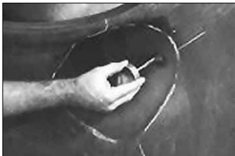
47. Нанесите тонкий слой вулканизационной жидкости № 760 (Chemical Vulcanizing Fluid) на обработанную поверхность. Дайте ей примерно 3-4 минуты для полного высыхания. При ремонте камерной шины обработайте область до синтетических нитей корда, нанесите на нее 2 слоя вулканизационной жидкости и увеличьте время высыхания вдвое. Важно, чтобы вулканизационная жидкость высохла полностью.
