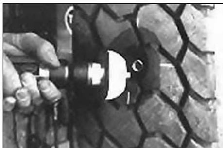
14. Обработайте шину с внешней стороны вокруг повреждения по периметру (от 40 до 50 мм) контурным кругом RH-102 совместно с полиуретановой вставкой RH-152. Скорость вращения пневмошеровальной машинки при обработке не должна превышать 5000 об/мин.
