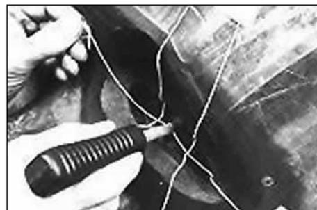
28. Положите в область пореза, с внешней стороны шины, хлопчатобумажные нити для вентиляции, чтобы снять давление с корда (внутри поврежденной части корда при вулканизации накапливается воздух). Закрепите концы нитей на внешней стороне шины примерно на расстоянии 75 мм от обработанной зоны повреждения.
