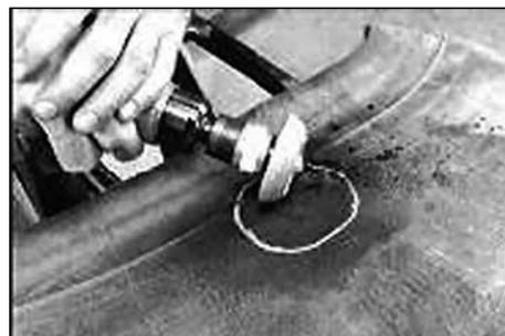
6. Обработайте ремонтируемую область механически. Это необходимо для удаления технологических неровностей и верхнего слоя поверхности камеры. При обработке используйте инструмент, скорость вращения которого не превышает 5000 об/мин (пневмошорохо-вальную машинку S1036) и шлифовальный круг S2032 совместно с полиуретановой вставкой S2033.
