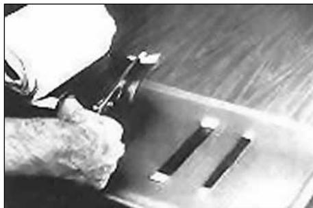
25. Нарезьте достаточное количество полос из сырой резины толщиной 3 мм, чтобы заполнить обработанный порез. Предварительно положите полоски резины на нагревательный стол при температуре примерно 49-55°C.
