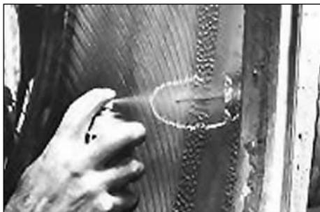
7. Определив, что шина подлежит ремонту, очистите ее внутреннюю поверхность. Нанесите аэрозольный очиститель-обезжириватель № 704 (Rub-O-Matic) на поврежденную область шины.
