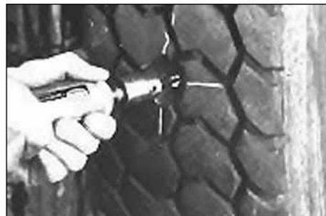
9. Отрежьте с помощью бор-фрезы карбидной № 284 (Carbide Router) на высокооборотной пневмошеровальной машинке S-1034 или S-1039 (при минимальной скорости вращения 20000 об/мин.) все концы поврежденных нитей корда. Расположите фрезу под углом 90° к нити корда. Нити стального корда должны быть отрезаны до самой резины. Убедитесь, что все ржавые или болтающиеся нити удалены.
