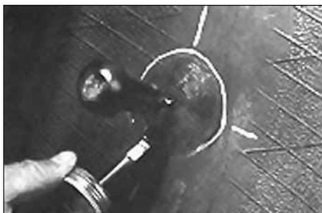
13. Нанесите слой клея №760 (Chemical Vulcanizing Fluid) на обработанную поверхность. Дайте клею примерно 3-4 минуты для того, чтобы он полностью высох. При работе в помещении с высокой влажностью или низкой температурой необходимо увеличить время высыхания.
