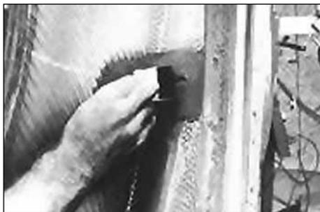
24. Вырежьте полоску сырой резины (Tech Vul-Gum) толщиной 3 мм и по ширине на 25 мм больше, чем размеры обработанного повреждения. Расположите ее с внутренней стороны шины таким образом, чтобы порез располагался строго по центру.
