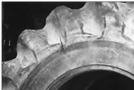
1. Если шина была заполнена специальной жидкостью для балласта или другая жидкость попала внутрь, удалите всю жидкость. Шина должна просохнуть полностью перед ее проверкой как минимум, 24 часа.
