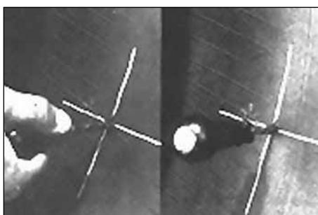
5. Определите размер, угол и глубину прокола снаружи и изнутри с помощью спирального шила № 915 (Spiral Cement Tool).
