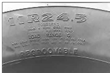
21. По сведениям, указанным на боковой поверхности шины, определите ширину профиля шины, а также является ли она камерной или бескамерной.
