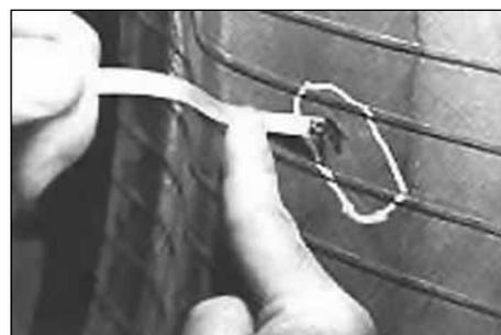
4. Измерьте расстояние между краем борта шины и краем повреждения. Повреждение не должно находиться близко к месту посадки на диск (в неремонтируемой зоне шины A-B).
