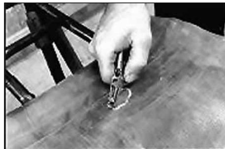
2. Если это порез, то его необходимо обязательно обработать, закруглив края пореза для предотвращения увеличения разрыва в дальнейшем.
