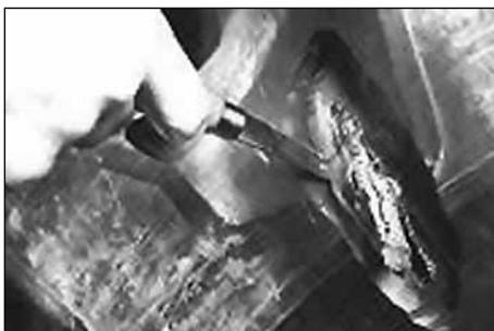
12. Используя нож № 940 или № 941 окончательно удалите резину из поврежденного места. Нож должен быть направлен под углом 90° к шине.
