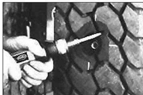
15. При ремонте повреждений в протекторе для лучшего последующего приклеивания вулканизирующей резины используйте шероховальный карандаш RH-625 для обработки канавок протектора. Скорость вращения пневмошеровальной машинки при обработке не должна превышать 5000 об/мин.
