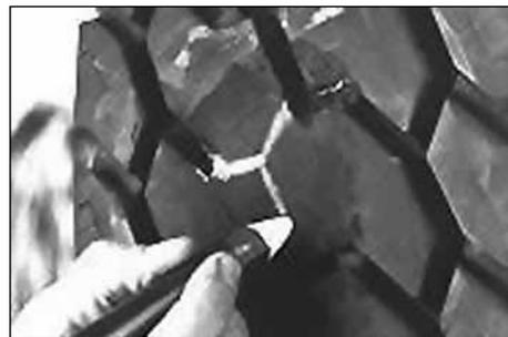
51. Если вулканизированное место закрывает канавку рисунка протектора Вы можете нарезать протектор заново в месте ремонта. Это обеспечит необходимую гибкость отремонтированному месту повреждения и исключит нагрев шины в этом месте. Сначала отметьте канавки маркировочным мелом.
