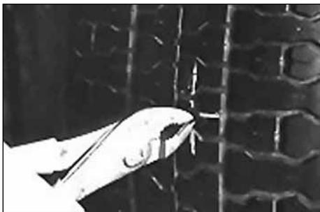
16. Зажмите плоскогубцами металлический держатель с внешней стороны покрышки и вытяните ножку грибка. Если металлический держатель отделится от ножки, когда ножка грибка выйдет из прокола, зажмите ее плоскогубцами и тяните до полной установки грибка, пока подложка не коснется поверхности покрышки изнутри.
