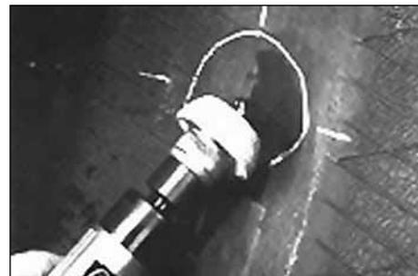
9. Обработайте отмеченную область мелкозернистой абразивной полусферой RH-102 или S2032. Скорость вращения дрели S1036 при обработке не должна превышать 5000 об/мин. Необходимо использовать защитные очки. При обработке внутренней поверхности шины старайтесь не задеть нити корда.
