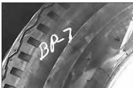
19. Напишите размер выбранного пластыря снаружи на шине.
