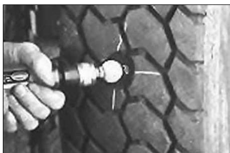
11. Удалите все неровности с помощью шероховального шарика RUBBERHOG RH-553 с зернистостью 390SSG на низкооборотной пневмошеровальной машинке S-1036 (максимальная скорость вращения 5000 об/мин) или S-1032 (максимальная скорость вращения 2500 об/мин).
