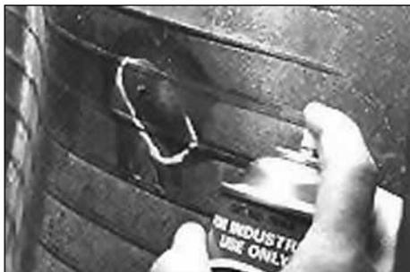
7. Нанесите аэрозольный очиститель-обезжириватель № 704 (Rub-O-Matic) на отмеченную область шины. Очистите ремонтируемую область изнутри шины.
