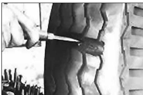
10. Используя нож № 940 или № 941, окончательно удалите резину из поврежденного места шины. Нож должен быть направлен под углом 90° к поверхности шины.
