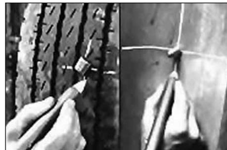
2. Обозначьте место повреждения шины с внешней и внутренней стороны с помощью маркировочного мела № 951.
