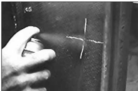
7. Нанесите аэрозольный очиститель № 704 (Rub-O-Matic) на отмеченную область покрышки. Очистите область 50 мм в диаметре.
