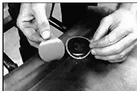
4. Выберите подходящую латку для ремонта повреждения на камере. Латка должна перекрывать размеры повреждения на 15 мм со всех сторон.
