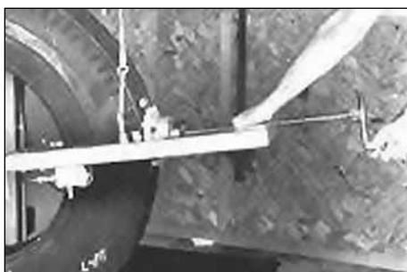
37. После окончания процесса вулканизации отсоедините линию подачи воздуха и снимите вулканизатор с шины. Дайте ей остыть, а затем, используя нож, отрежьте остатки резины. Это обычно не требуется, если Вы используете вулканизатор с пневмоприжимом.
