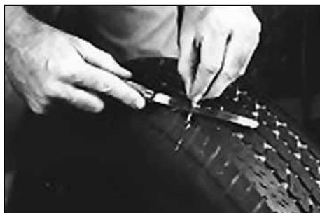
14. Отрежьте оставшиеся на поверхности части шнура с внешней стороны шины.
