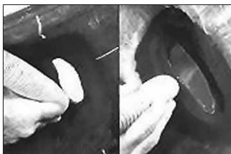
18. Очистите пылесосом обработанную область, чтобы удалить частицы резины и резиновой пыли с внутренней и внешней стороны шины.
