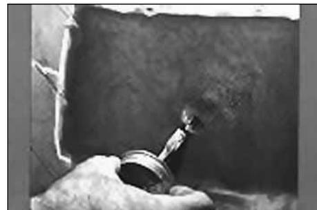
42. Нанесите тонкий слой вулканизационной жидкости № 760 (Chemical Vulcanizing Fluid) на обработанную поверхность. Дайте ей примерно 3-4 минуты для полного высыхания. При ремонте камерной шины обработайте область до синтетических нитей корда, нанесите на нее 2 слоя жидкости и увеличьте время высыхания вдвое. Важно, чтобы вулканизационная жидкость высохла полностью.
