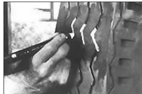
53. Вы можете нарезать протектор заново в месте ремонта, если вулканизированное место закрывает канавку рисунка протектора. Это обеспечит необходимую гибкость отремонтированному участку и исключит нагрев шины на нем. Сначала отметьте канавки маркировочным мелом.
