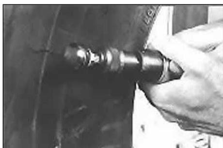
10. Удалите резину с внешней стороны шины в месте повреждения с помощью низкооборотной пневмошеровальной машинки S1036 (максимальная скорость вращения 5000 об/мин) или S1032 (максимальная скорость вращения 2500 об/мин) и фрезы для выборки резины S-2045 или S-2046. **ВНИМАНИЕ!** Старайтесь не касаться стальных нитей корда, чтобы не повредить их при выполнении данного пункта.
