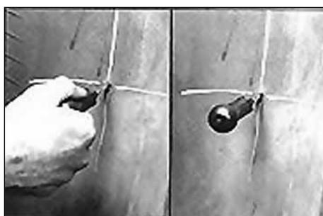
5. С внутренней стороны шины определите угол повреждения, используя спиральное шило № 915 (Spiral Cement Tool).
