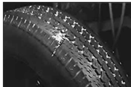
15. Проверьте отремонтированную шину на герметичность с помощью концентрата контроля утечки для поиска проколов (Tech Check) № 751. Если не будет пузырьков воздуха, шина готова к эксплуатации.
