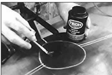
10. Нанесите тонкий слой вулканизационной жидкости № 760 (Chemical Vulcanizing Fluid) от центра ремонтируемой области к краям. Не наносите дополнительный слой, так как это только увеличит время его высыхания. Дайте вулканизационной жидкости примерно 3-4 минуты для полного высыхания.
