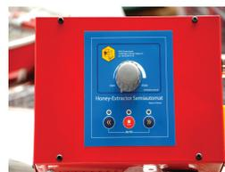
У этого типа автомата есть возможность работать в одном автоматическом или ручном режимах. У этого управления заводские установки. Чтобы привести в движение полуавтоматически порядок надо одновременно нажать два боковых нажима.
