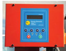
Автомат делает возможным ввести 5 собственных циклей программирования (программы с 4 до 8, у первых трех программ заводские установки. Каждый введенный цикл состоит из 7 шагов, последний — 7 шаг определяет время останвлиения движения корзины медогонки. Каждый шаг определен при помощи трьох параметров — время начала шага, заданной скорости и движения корзины медогонки.
